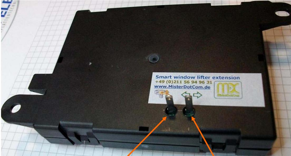
Stecken Sie den Stecker des schwarzen Kabels auf diesen Pin mit dem Schlüsselsymbol
