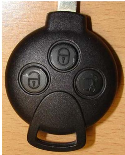
**Komfortschließung:** Automatisches Hochfahren aller Fenster bei verschließen des Fahrzeuges mit der Fernbedienung.
