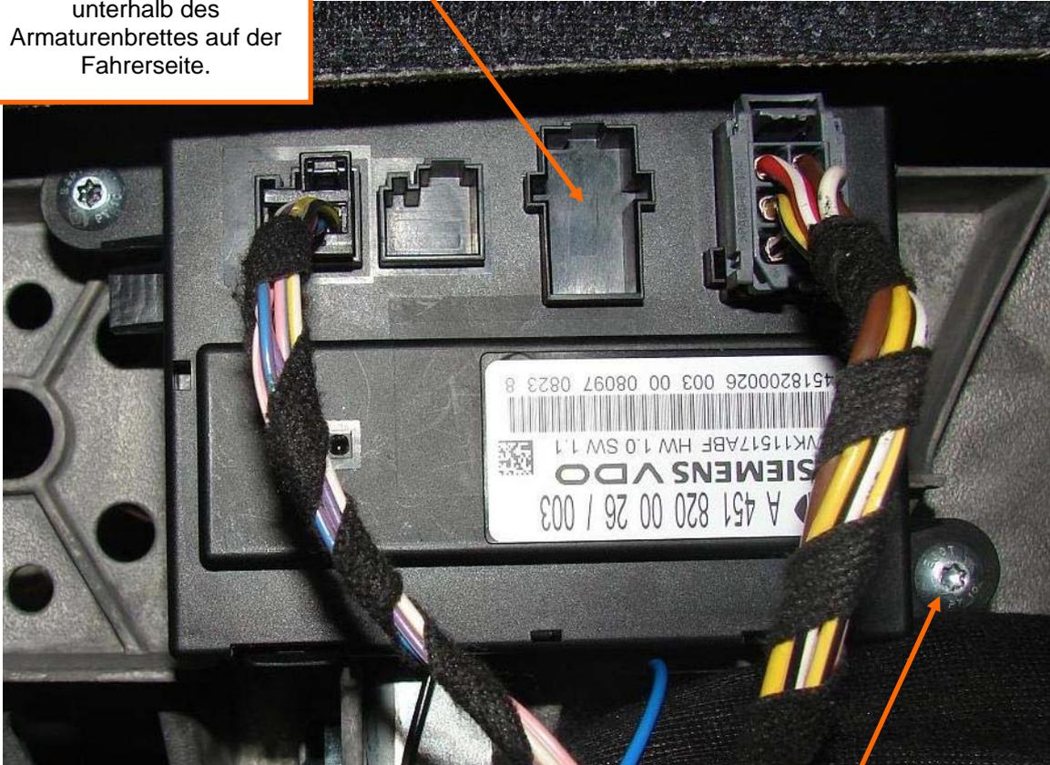
Lösen Sie diese Schrauben
