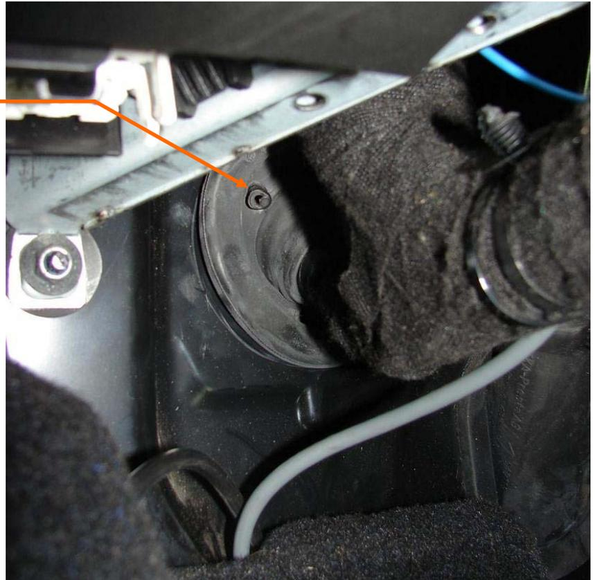
Verbinden Sie das **blaue** Kabel mittels des mitgelieferten Schneidverbinders mit dem **schwarz/weißen** Kabel des linken Seitenblinkers. Sie finden dieses Kabel vorne links unter der Haubenabdeckung oberhalb des Scheinwerfers.
